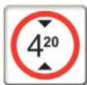
Altura libre restringida
