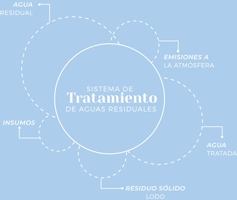
Figura 48: Esquema conceptual de un sistema de tratamiento de aguas residuales (tomado de Noyola et al., 2013).
