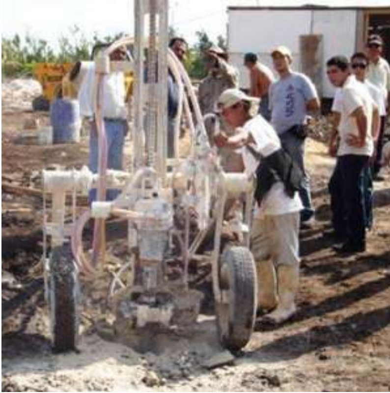
Figura 28: Estudio de suelos. Penetración estándar. Por: A&D asociados.
