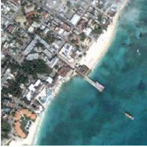
Figura 41: Sedimentación y erosión costera (norte y sur respectivamente) generada por el muelle fiscal de Playa del Carmen. Por: ASK.
